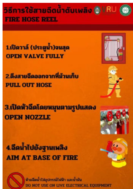
โปสเตอร์วิธีการใช้สายฉีดน้ำดับเพลิง
