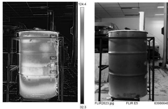
รูปที่ 7 ภาพถ่ายทางความร้อนของเตาอบแบบไม่หุ้มฉนวน
